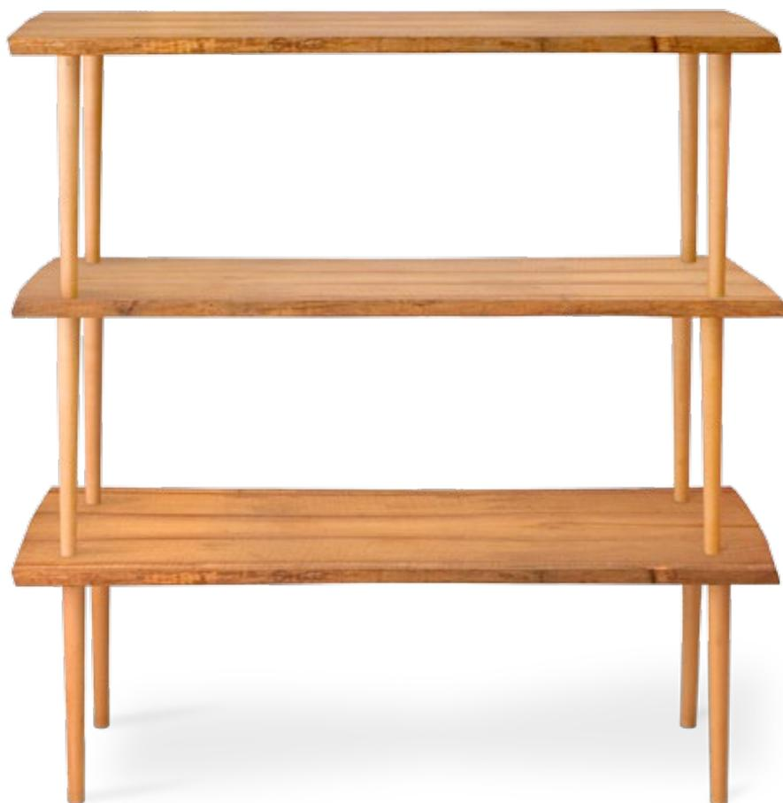
scaffale costituito da tre tavoli in legno di castagno. il piano è ottenuto da due tavole piattate a mano e giuntate a libro. le gambe, leggermente coniche e alloggiate nel piano del tavolo inferiore, sono fissate al telaio con incastri a cilindro e cuneo.
