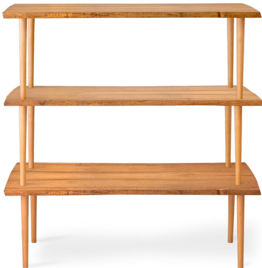
scaffale costituito da tre tavoli in legno di castagno sovrapposti. il piano è ottenuto da due tavole piallate a mano e giuntate a libro. le gambe, leggermente coniche e alloggiate nel piano del tavolo inferiore, sono fissate al telaio con incastri a cilindro e cuneo.
